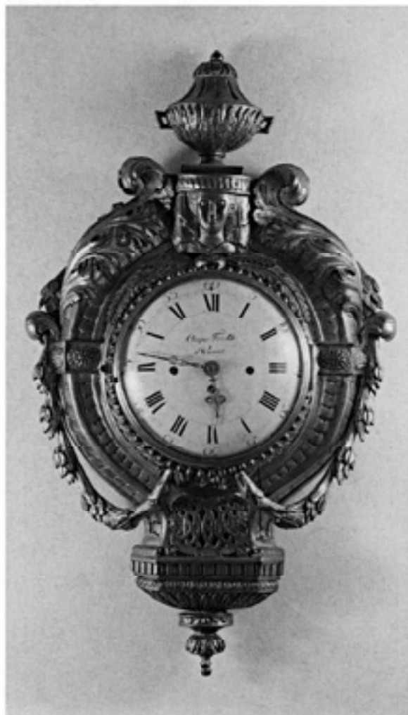
158 Carteluhr von Caspar Frickh, Wien, I. V. 18. Jh.; vergoldetes Holzgehäuse, Emailzifferblatt, Ankerhemmung, Wiener \frac{1}{4} -Schlag auf Glocken
