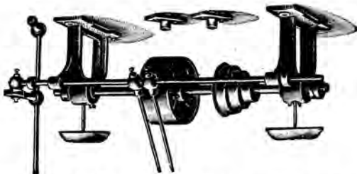
Nr. 7004. Deckenvorgelege für Kraftbetrieb , komplett zum Anschrauben, für größere Drehbänke usw., Durchmesser der Voll- und Leerscheibe 200 mm, Breite 50 mm, Stufendurchmesser 145, 110 und 75 mm, Stufenbreite 30 mm, Länge der Welle 900 mm, Dicke der Welle 30 mm, Tourenzah l ca. 200 bis 220 pro Minute . . . Stück Mk. 35,—
