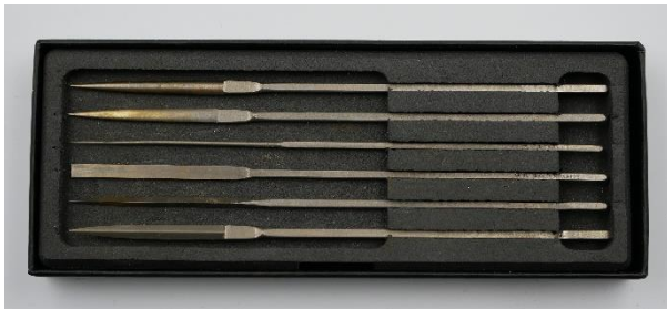
Satz Echappement Schmirgelfeilen in verschiedenen Querschnittsformen.
