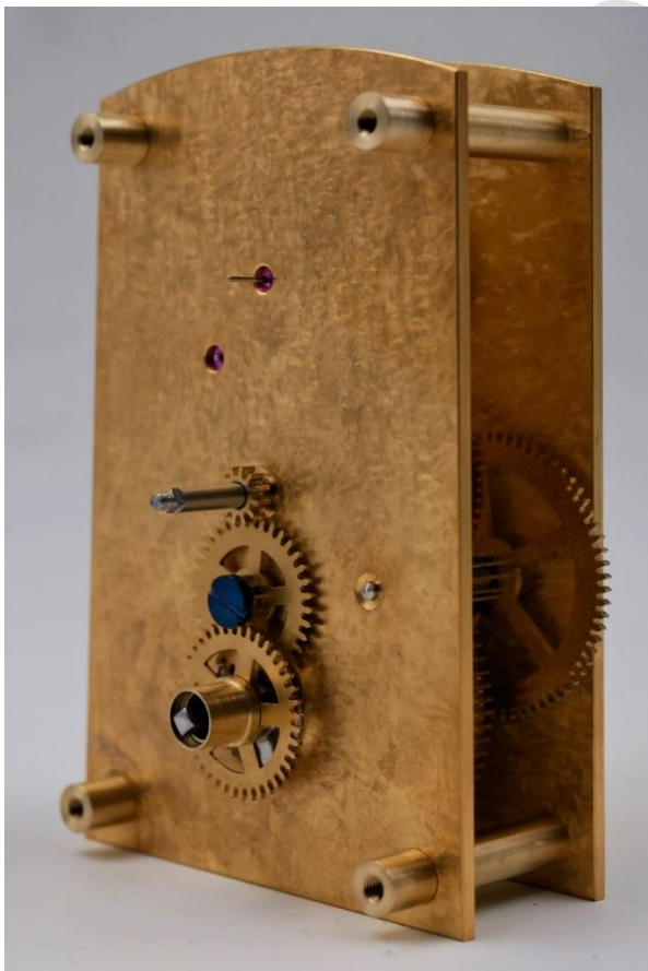
Uhrwerk mit fertigen, entgrateten und finissten Platinen.
