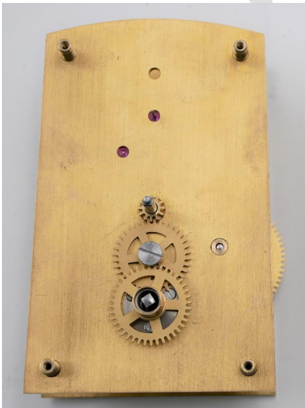
Uhrwerk mit roh angefertigten Platinen. Die Funktion ist zwar gegeben, die Feinarbeit (Entgraten, Finissieren, usw.) fehlt jedoch noch.
