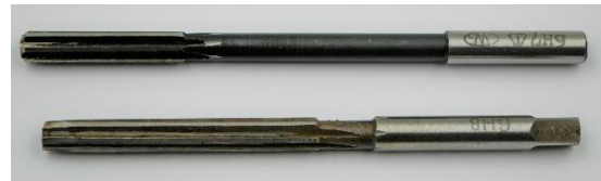
Oben: Maschinenreibahle mit zylindrischem Schaft zur Benutzung in der Bohr- oder Drehmaschine. Unten: Handreibahle mit Vierkant zur Aufnahme in einem Handhalter.
