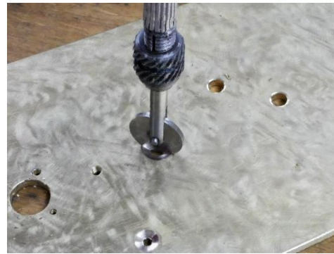
Entgraten mit einem Rollsenker.
