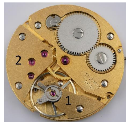
Taschenuhrwerk mit (Unruh-) Kloben (1) und (Räderwerks-) Brücke (2).
