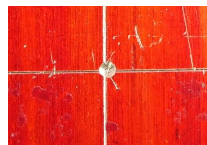
Wenn die Senkung nicht direkt exakt positioniert ist...
