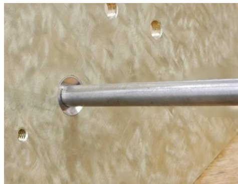
Abermaliges Entgraten mithilfe einer Glättahle.
