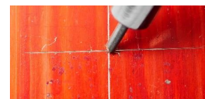
... lässt sich dies durch schräghalten des Senkers korrigieren.
