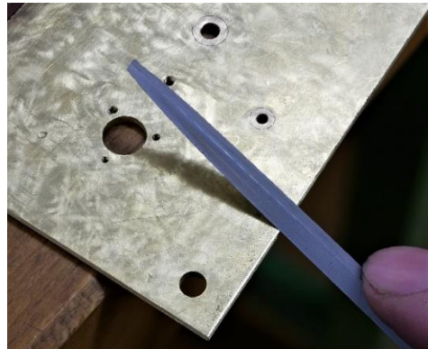
Anfeilen der 45° Fase.
