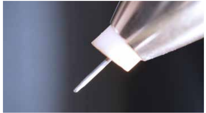
WLA Ø 0,6 mm nach 700 Punkten / after 700 spots
