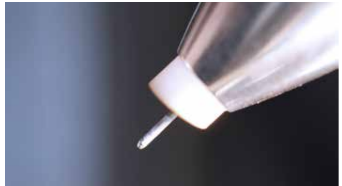
WLA Ø 0,6 mm nach 700 Punkten / after 700 spots
